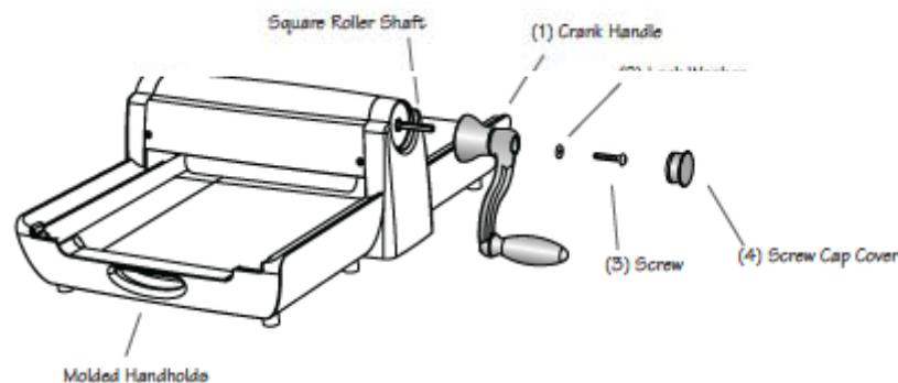
1. Вставьте шуруп (3) через стопорную шайбу (2), затем вставьте их в рукоятку (1).
