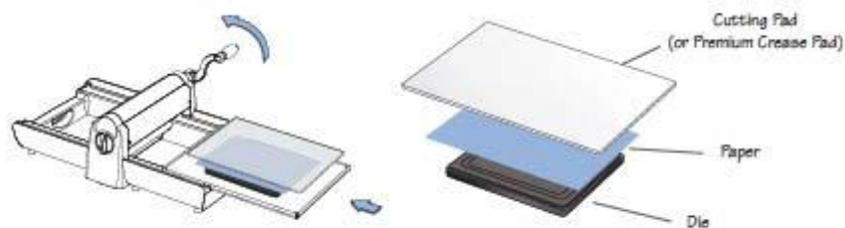
Формы для вырубки SureCut, ClearCrop могут быть использованы в машинке Big Shot БЕЗ адаптера для вырубки и эмбоссирования 656251, т.к. эти формы толще чем Bigz. Поместите форму прямо на выдвижной поддон 656254. Затем положите бумагу, сверху положите 1 Пластина для вырубки 656253. Если вы используете форму Elisson SureCut Crease-Rule, вместо Пластины для вырубки 656253 используйте Пластину для сгибов 656494.
